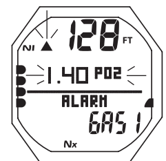
Fig. 93B - PO2 ALARM MAIN
